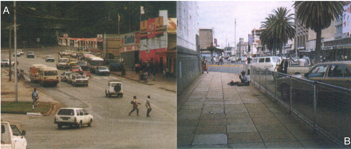
Figura II-5 A. Conflictos de accesos frontales y de peatones-vehículos en distribuidor de distrito B. Acera protegida en un distribuidor de distrito
