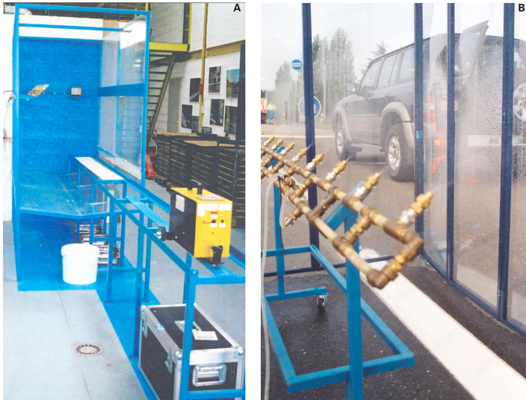
FIGURA 2.3.22. MEDIDA DE LA RETRORREFLEXIÓN BAJO CONDICIONES DE LLUVIA (SIMULADA). A) EN LABORATORIO, B) EN CARRETERA (CON PROTECCIÓN DEL VIENTO)
