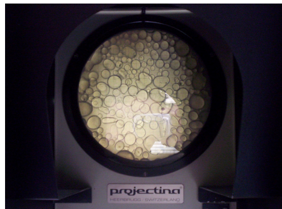
FIGURA 2.3.17. DETERMINACIÓN DEL % DE MICROESFERAS DE VIDRIO DEFECTUOSAS.
