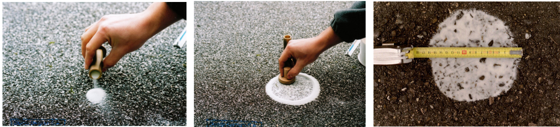
FIGURA 2.3.24. MEDIDA DE LA PROFUNDIDAD MEDIA DE TEXTURA DEL PAVIMENTO MEDIANTE EL MÉTODO VOLUMÉTRICO (ALTURA DE ARENA) (UNE EN 13036-1)
