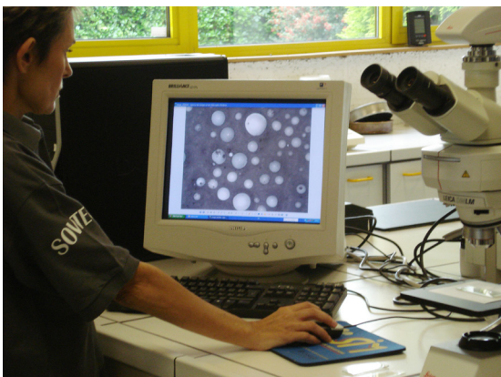
FIGURA 2.3.17. DETERMINACIÓN DEL % DE MICROESFERAS DE VIDRIO DEFECTUOSAS.
